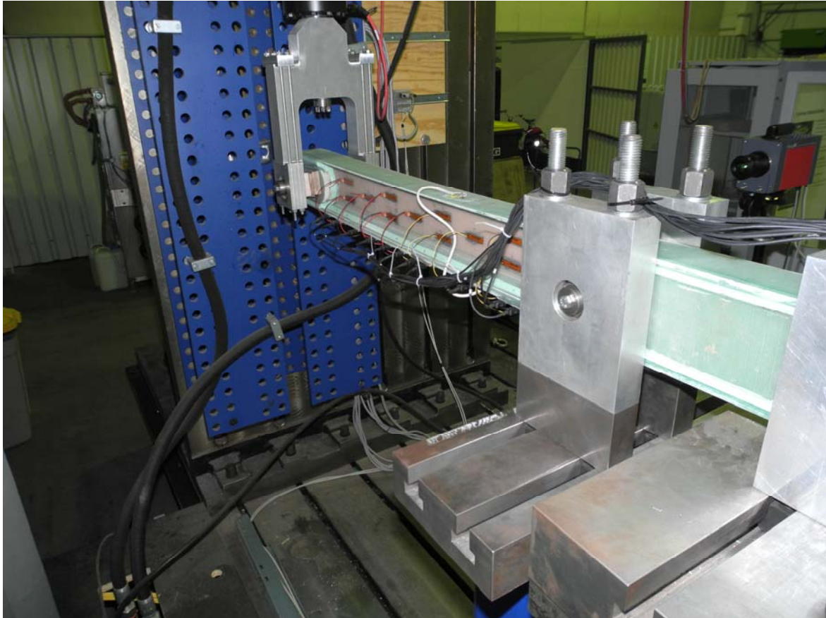
Abb. 2. Testbalken 2 beim asymmetrischen Drei-Punkt-Biegeversuch, Schallemissionssensoren (DuraAct Flächenwandler 11 x 41 mm) auf dem Schubsteg, Vorverstärker auf der Unterseite des Balkens, rechts: Thermographiekamera
